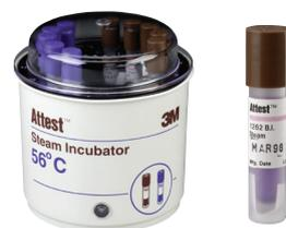
3M™ 生物培育機#118可配合Attest™ 1262生物指示劑使用，可於48小時內提供準確測試結果。
