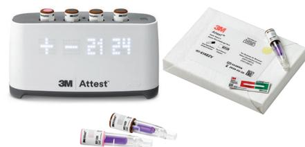
3M™ Attest™ 490M生物指示劑快速閱讀器，用於讀取Attest™ 1492V生物指示劑熒光變化，可於24分鐘內提供準確測試結果。
